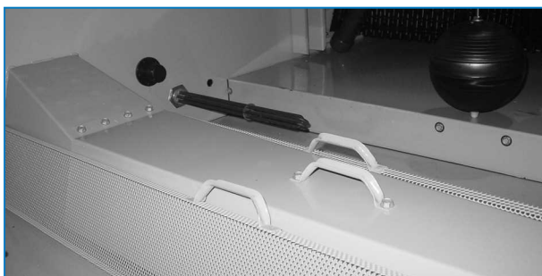
Kaltwasserbecken und Beckenlochblechsiebe
