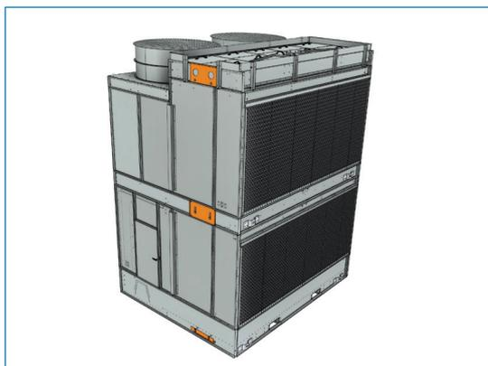
Les attaches de l'échelle externe sont installées en usine.
