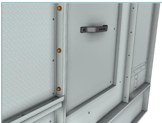
Assurez-vous que les trous de fixation de l'atténuateur d'aspiration sont alignés avec les trous de l'appareil. Fixez à l'aide de goujons.
