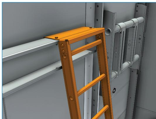
Soulevez l'échelle en place et placez les boulons présoudés dans les trous de montage du canal de support supérieur. Aucune autre fixation n'est requise.
