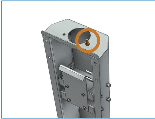
Installez un boulon et un écrou face vers le haut du côté de la porte du socle.
