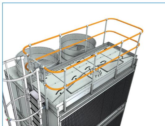
Faites glisser le garde-corps et serrez à l'aide de vis de réglage.
