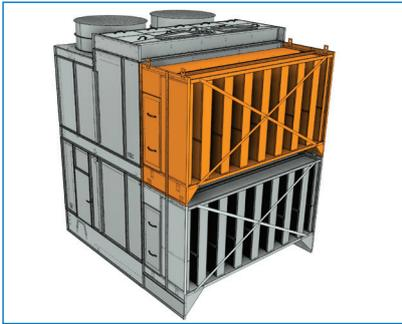
Soulevez l'atténuateur d'aspiration supérieur au-dessus de l'atténuateur d'aspiration inférieur. Assurez-vous que les trous de fixation de l'atténuateur d'aspiration sont alignés avec les trous de l'appareil.
