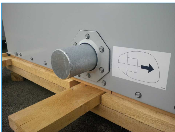
Raccord de batterie inférieure fermé sur les condenseurs évaporatifs.
