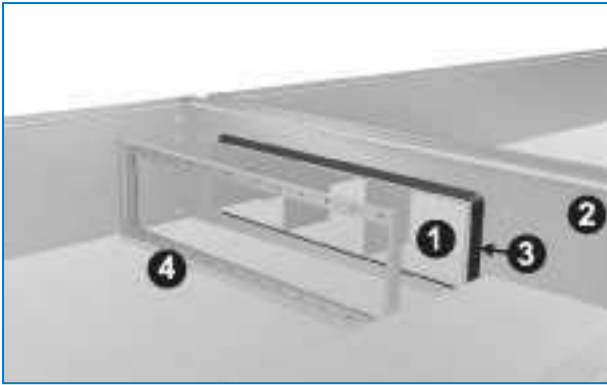
Einbau des Abdeckrings
